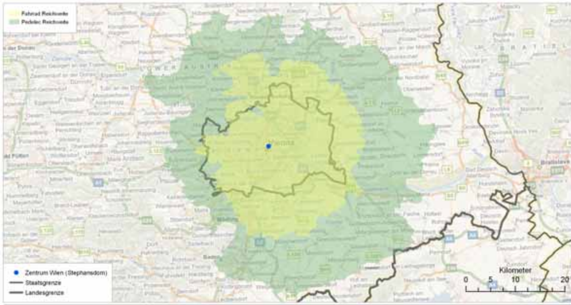
Abb. 33: Reichweitenvergleich Fahrrad – Pedelec bei 500kcal Energieverbrauch
